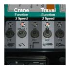
**2-Speed Functions** -Standard on MC305-2, MC405, CC1485-1
